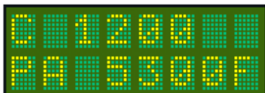
Encoder altitude for "pressure altitude" (1013mB or 29.92HG)
